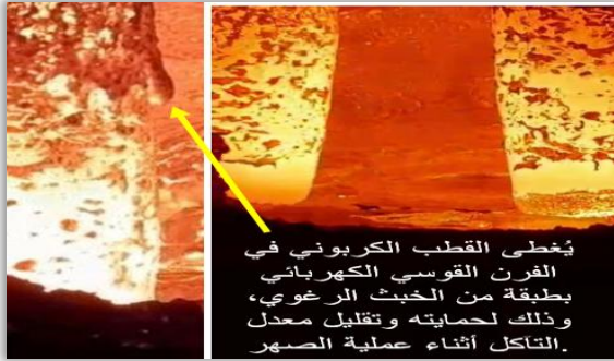
الأقطاب الكربونية داخل فرن القوس الكهربائي بصنع الصلب (1) بالشركة الليبية للحديد والصلب.
